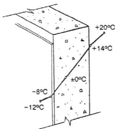
б) Наружная стена с теплоизоляцией толщиной 75 мм
